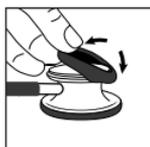
Para acoplar a borracha antifrio para sino, coloque um lado da borracha na borda do auscultador e estique a borracha sobre toda a extensão da peça.
