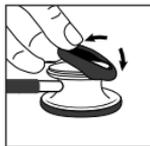
Para montar a membrana da campainha anti-arrepios, coloque um lado da manga na borda da campânula e estique-a por cima e em volta da borda da campânula.
